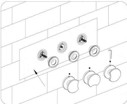
5. Installez les poignées et ajustez les pour qu'elles soient dans la bonne position. Fixez-les à l'aide des vis.
