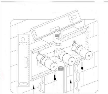
1. La profondeur d'encastrement est de 67 à 80 mm pour un mur fini. Installez le corps d'encastrement, puis assurez vous qu'il soit de niveau. Raccordez les arrivées d'eau chaude / eau froide et les sorties pour la tête de douche et douchette à main.
