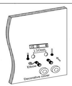
Enroulez le ruban d'étanchéité autour du filetage des coudes et raccordez les à l'arrivée d'eau.
