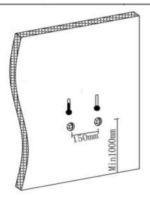
Vérifiez que les deux trous d'arrivée d'eau sur le mur sont parallèles.
