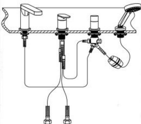
4. Connectez les différents éléments entre eux à l'aide des flexibles de raccordement.
