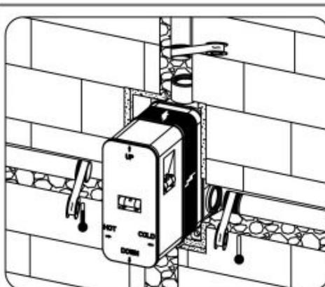
2. Raccordez les deux flexibles à l'arrivée d'eau chaude et d'eau froide ainsi que l'arrivée d'eau de la tête de douche et douchette à main.
