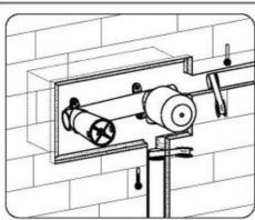
Raccordez les deux flexibles à l'arrivée d'eau chaude et d'eau froide, puis vérifier s'il n'y a pas de fuites.
