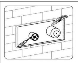
Recouvrez à l'aide de béton, puis lorsque le béton est sec, coupez avec un couteau le long des bordures.
