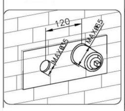
4. Enveloppez le connecteur du bec avec du ruban d'étanchéité. Puis installez la plaque.
