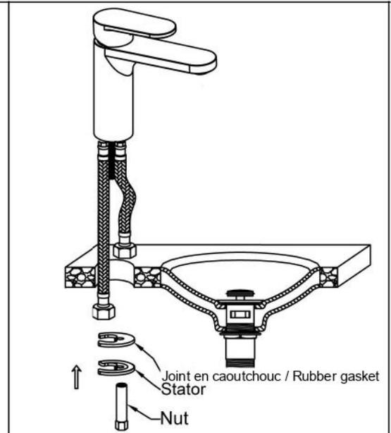
3. Installez les deux flexibles dans le trou percé.
