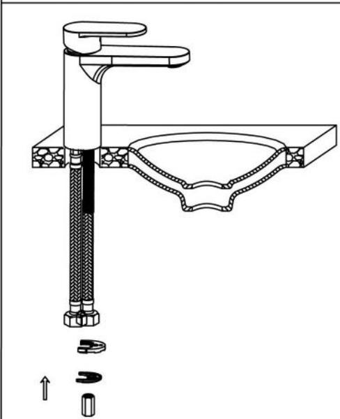
4. Réglez le stator en dessous de l'orifice, vissez l'écrou hexagonal pour garder le robinet dans la bonne direction.
