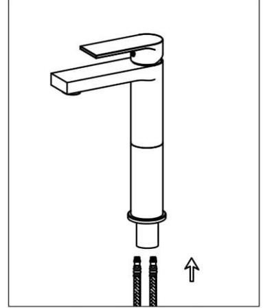
2. Vissez et serrez à la main les flexibles d'eau chaude et froide sur le robinet. NE PAS utiliser de pince !
