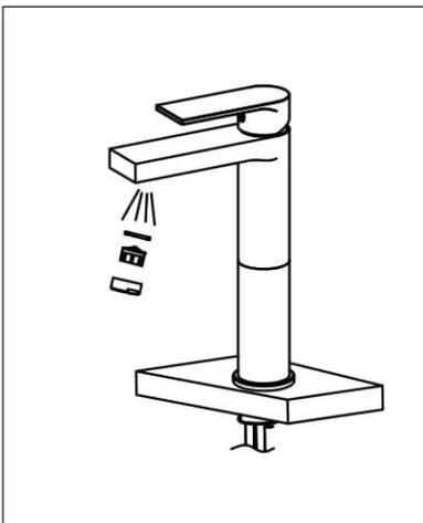
6. Retirez l'aérateur et ouvrez le robinet pendant 1 minute pour éliminer les débris. Fermez le robinet et réinstallez l'aérateur.
