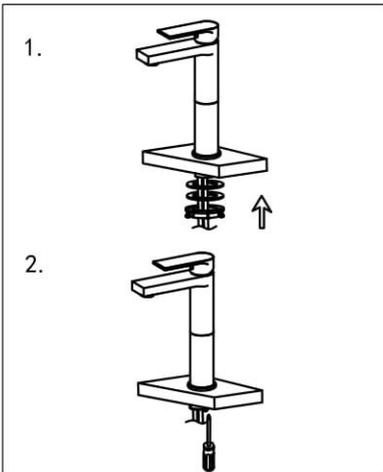
4. Réinstallez la rondelle en caoutchouc, puis métallique et l'écrou. Serrez à la main puis à l'aide d'un tournevis pour les vis de l'écrou.
