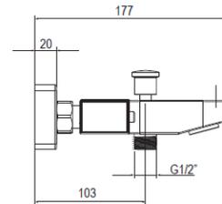
Pression: min. 0,5 bar / max. 10 bar
