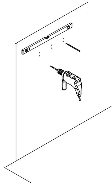
3. Insérez les chevilles murales et les vis de montage dans le mur. Installez les supports. Mettez un peu de colle sur la surface des supports.
