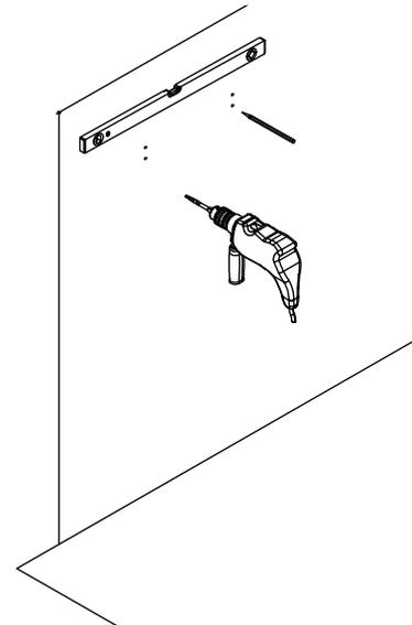
3. Insérez les chevilles murales et les vis de montage dans le mur.
